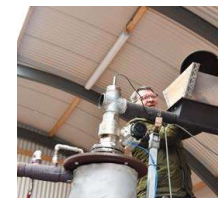
Rob Vasbinder doseert weer een lading graspellets in de installatie die hier synthesesgas en Biochar van maakt. Uit het synthesesgas kan elektriciteit of waterstof worden gemaakt. Door de installatie op te schalen denkt Vasbinder zo'n 500 kg waterstof per dag te kunnen maken uit bermgras.
