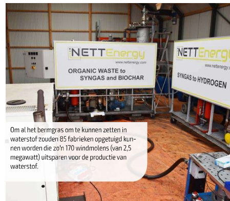
Rob Vasbinder doseert weer een lading graspellets in de installatie die hier synthesesgas en Biochar van maakt. Uit het synthesesgas kan elektriciteit of waterstof worden gemaakt. Door de installatie op te schalen denkt Vasbinder zo'n 500 kg waterstof per dag te kunnen maken uit bermgras.
